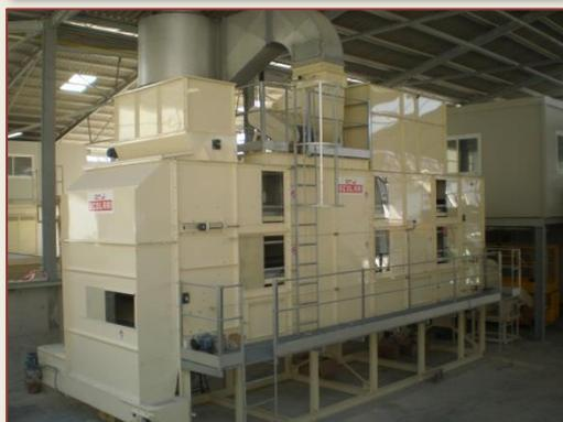
Le produit à sécher doit être préalablement broyé avec une granulométrie généralement de 0/30 mm, et n'excédant pas 100 mm .
